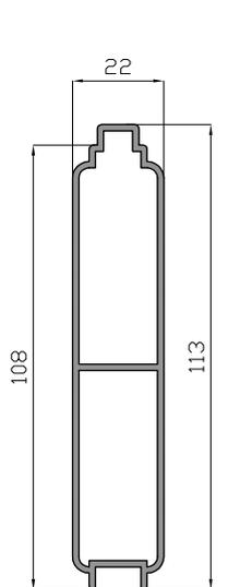
Lama machembrado 108 mm
